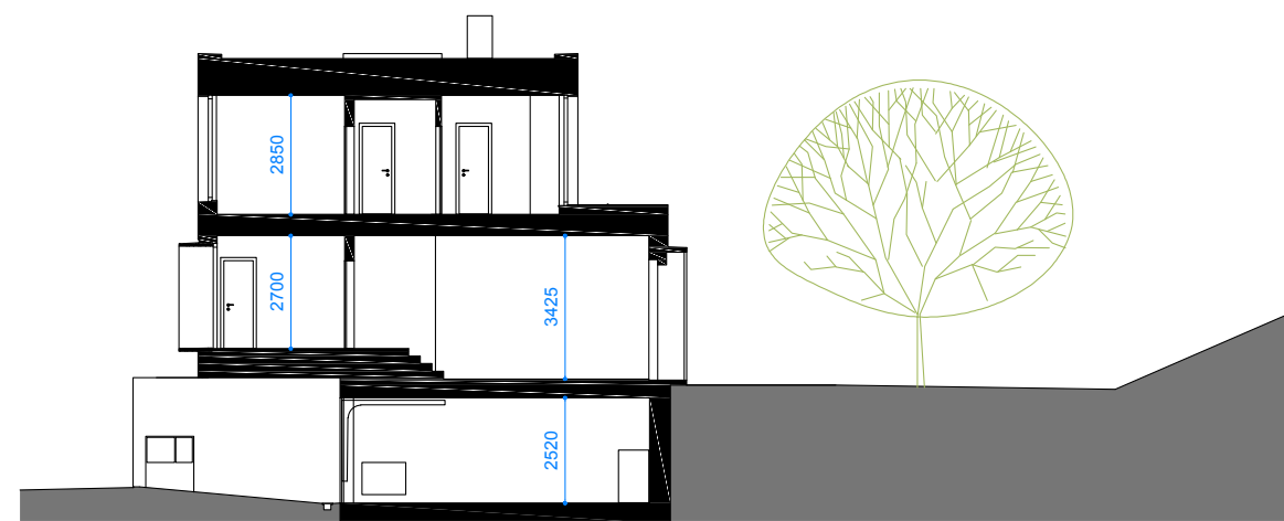
příčný řez | section view
